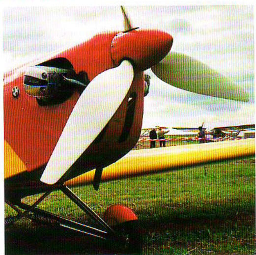
BMW-Umbauten: links der Vierventiler RS 1100 in Ernst Haugs D-MILO, rechts der Ein-Liter-Zweiventiler in der D-MBCD, heute geflogen von Michael Stein. Die Auspuffkrümmer liegen wie beim Motorrad im Kühlluftstrom
