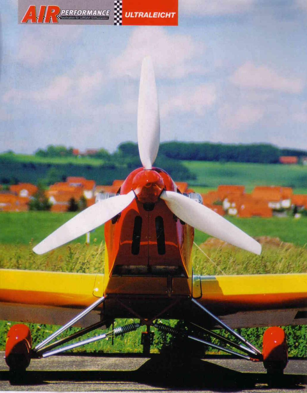
Rank und schlank: Der Sunrise besticht mit geringem Rumpfquerschnitt. Der Dreiblatt-Propeller wird über ein Getriebe sowie eine ausgeklügelte Fliehkraftkupplung angetrieben.
