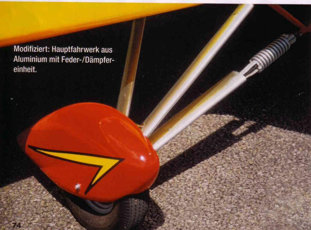
Modifiziert: Hauptfahrwerk aus Aluminium mit Feder-/Dämpfer-einheit.
