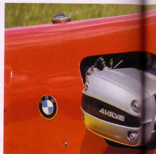
Flotter Antrieb: Der luft-/ölkühlte BMW-Boxer generiert dank Vier-ventiltechnik rund 100 PS und sorgt für formidable Flugleistungen.
